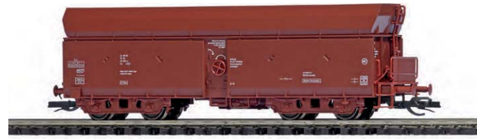
TT 31321 Kohlewagen Fal DR IV 111 Niesky Drehgestelle. Ohne Dach. Bühne geschlossen. Betriebsnummer: 35 50 655 3152 - 5
