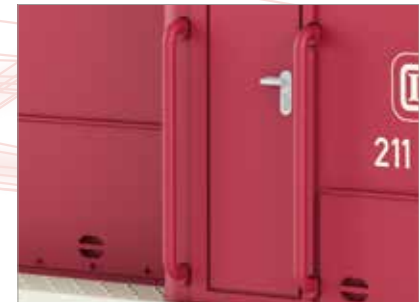
■ Freistehende Griffstangen am Führerhaus
