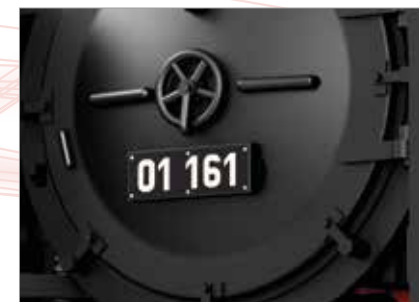
■ Rauchkammertüre mit Zentralverschluss
