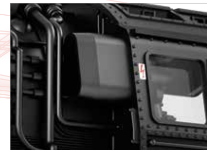
■ Führerhaus mit modernisierter Sichtblende
