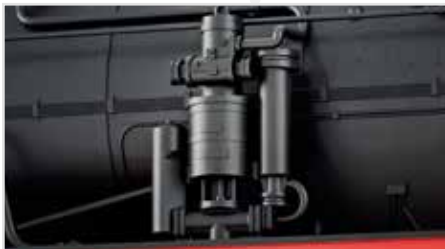
Speisepumpe Bauart Knorr KT1-250 mit Tolken-Steuerung
