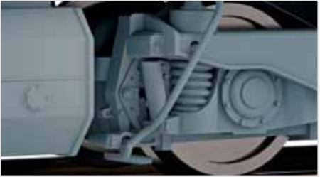
Aufwendige Nachbildung der Bremsanlage sowie Sandfallrohre
