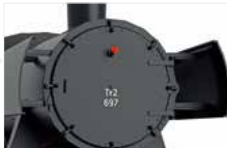
Rauchkammertüre in flacher Ausführung
