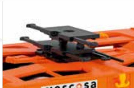
Mehrteilig ausgeführter Stützbock
