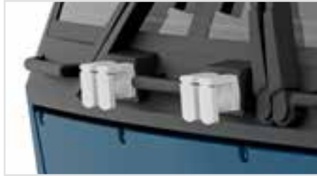
Filigrane extra angesetzte Griffstangen, UIC-Dosen und Scheibenwischer
