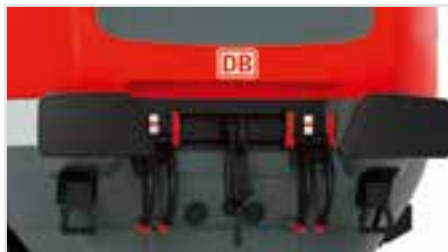
Aufwendig zugestützte Pufferbohle
