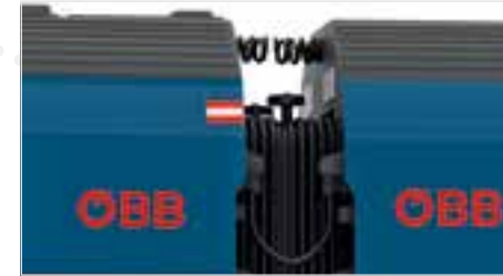
Nachbildung aller Übergangsleitungen zwischen den Wagen
