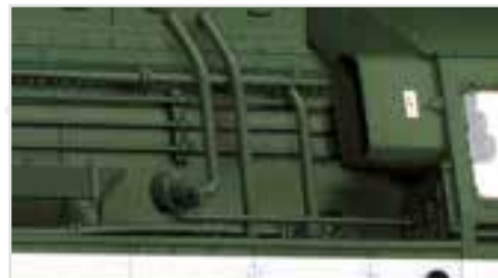
Korrekte Leitungsführung vor dem Führerhaus
