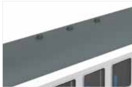
Separat angesetzte WLAN-Antennen
