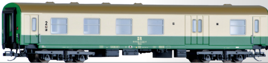
Gepäckwagen mit Behindertenabteil BDwsb der DR Baggage car with disabled compartment BDwsb of the DR
