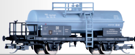
Säurekesselwagen Zd der DR, vermietet an VEB Chemische Werke Buna Acid tank car Zd of the DR
