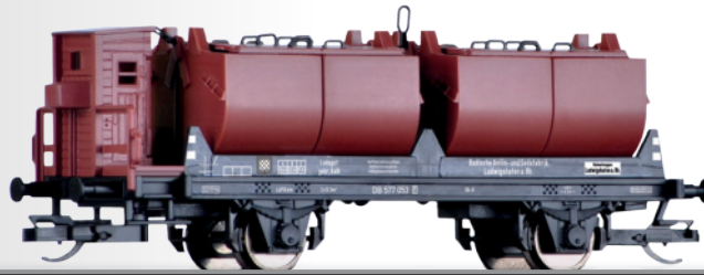
Kalkkübelwagen „Badische Anilin- und Sodafabrik“, eingestellt bei der DB Car for transport of limestone "Badische Anilin- und Sodafabrik" of the DB
