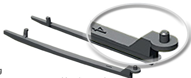
CAD-Abb. zeigt geänderte Weichenzunge
