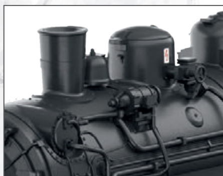
Turbo-Dynamo für elektrische Beleuchtung und Lätewerk zwischen Schornstein und Speisedom
